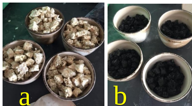
Gambar 1. a) Bonggol Jagung Sebelum Dipanaskan, b) Bonggol Jagung Setelah Dipanaskan pada suhu 400 °C
